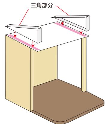
屋根は上からかぶせるように貼り合わせます。側面の壁に幕を貼り付けます。
